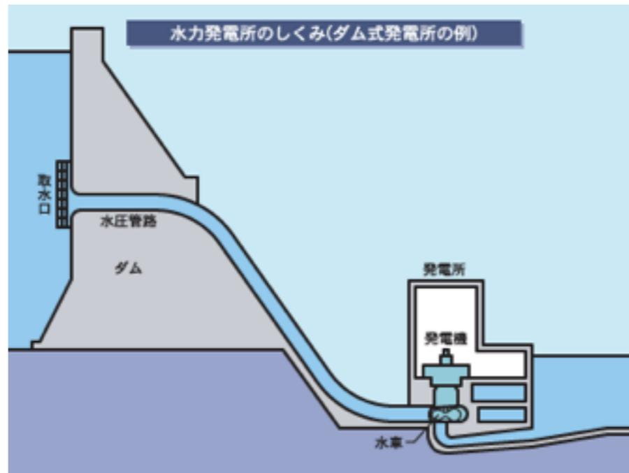
水力発電所のしくみ(ダム式発電所の例)
