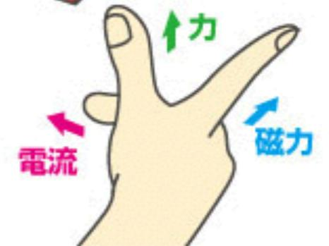
磁石(磁力)と力(回転)を使って「電気(電流)」を発生させます。
