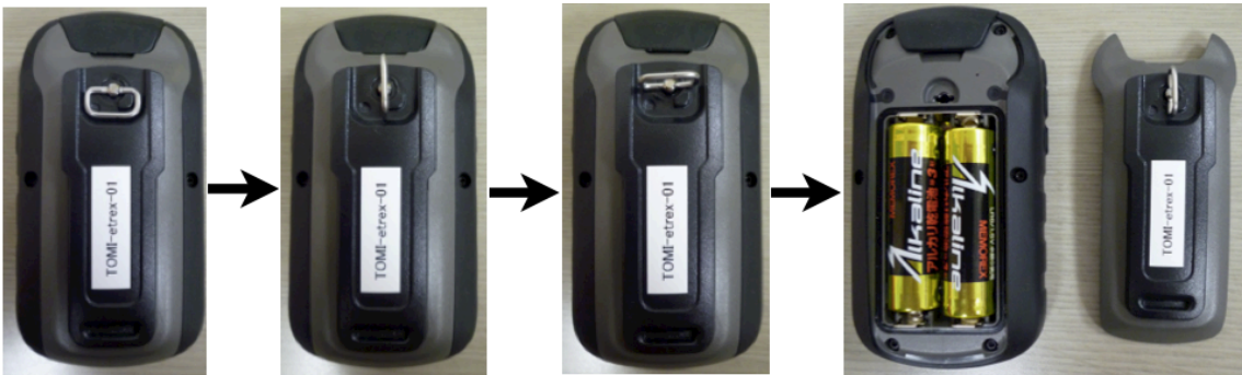
図 6.1 eTrex30J 電池交換の方法
