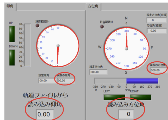
図 2.11 衛星追尾時のアンテナ制御パネル
