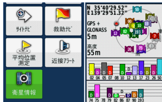
図 6.4 衛星情報の確認画面
