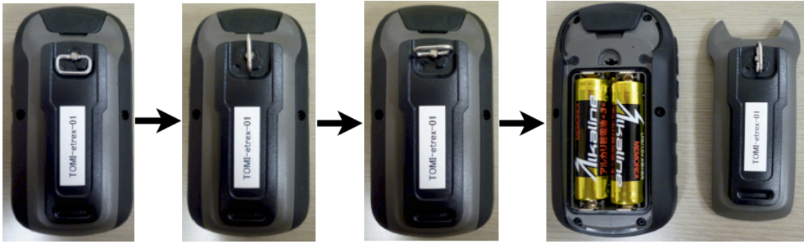
図 6.1 eTrex30J 電池交換の方法
