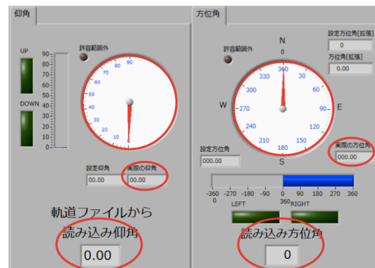
図 2.11 衛星追尾時のアンテナ制御パネル
