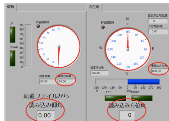
図 2.11 衛星追尾時のアンテナ制御パネル
